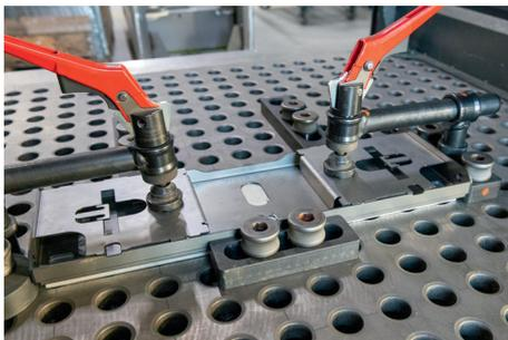
Ein durchdachtes, von uns selbstentwickeltes und modulares Spannsystem ermöglicht es uns, auch kleine Losgrößen flexibel, kostengünstig und mit höchster Präzision zu schweißen.
